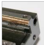
潤滑油乾涸殘留物 上儲油塊破損
