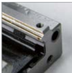
上儲油塊完好 供油正常 軌道面正常
